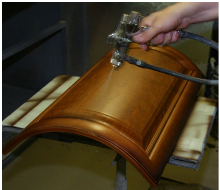
Ręczne malowanie frontów giętych wymaga od lakiernika ogromnego doświadczenia.
