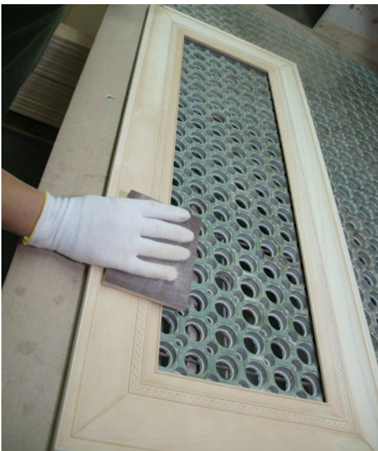
Szlifowanie to bardzo ważny etap w produkcji frontu.
