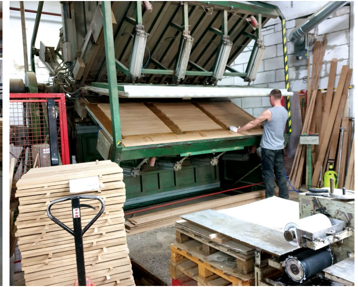
2 Vierseitenhobelmaschinen, Verleimpresse zu Herstellung von Massivholzplatten
