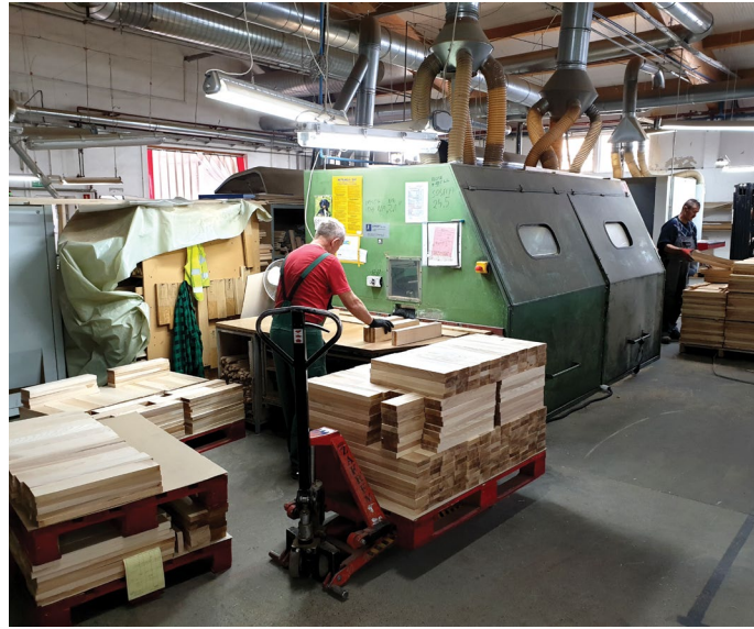
2 Vierseitenhobelmaschinen, Verleimpresse zu Herstellung von Massivholzplatten
