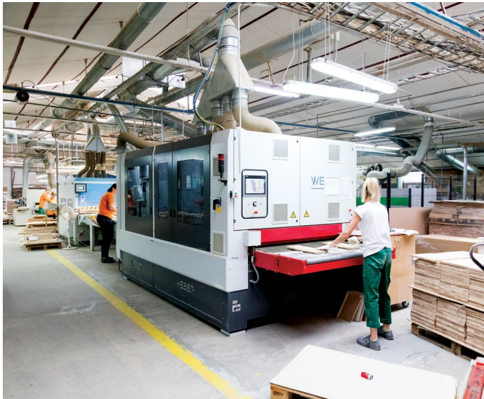
3 Schleiflinien, Manuelle Endbearbeitung des Elements
