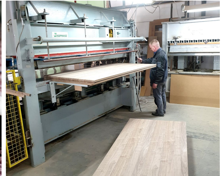
2 Vierseitenhobelmaschinen, Verleimpresse zu Herstellung von Massivholzplatten
