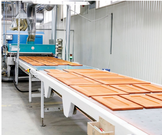
2 Lackierlinie, 4 Lackierkabinen, Anpassung der Lackiertechnik an die Kundenanforderung
