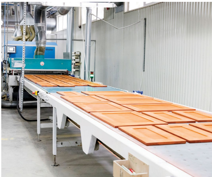
2 автоматические покрасочные линии, 4 покрасочные камеры адаптация технологии окраски к требованиям Клиента
